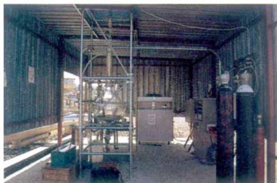
Abb. 12. Blick in die nach Norden offene Versorgungsplattform. Im Vordergrund links ist das Vorratsgefäß zu sehen. Im Hintergrund befindet sich der Prozeßkühler. Rechts an der Wand sind der Steuerschrank und die Gasarmaturen mit den drei Bomben für Stickstoff, Sauerstoff und Ethylen im Vordergrund zu erkennen.
